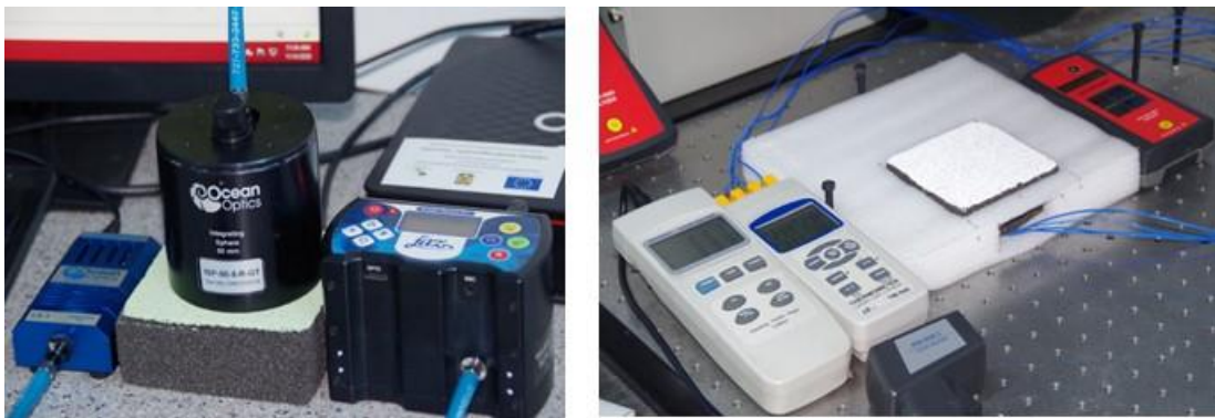
Fig. 9. Stand experimental pentru studiul reflectanței spectrale (stânga) și pentru studiul comportamentului termic al probelor de sticlă celulară funcționalizate (dreapta)
