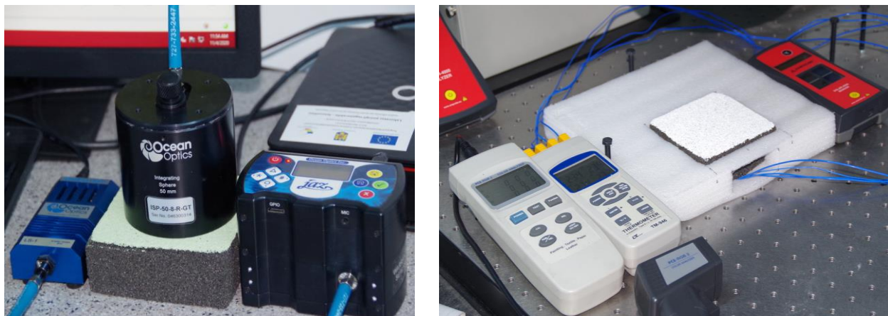
Figura 4. Foto: Stand experimental pentru studiul reflectanței spectrale (a) și pentru studiul comportamentului termic al bucăților de sticlă celulară funcționalizată (b)
