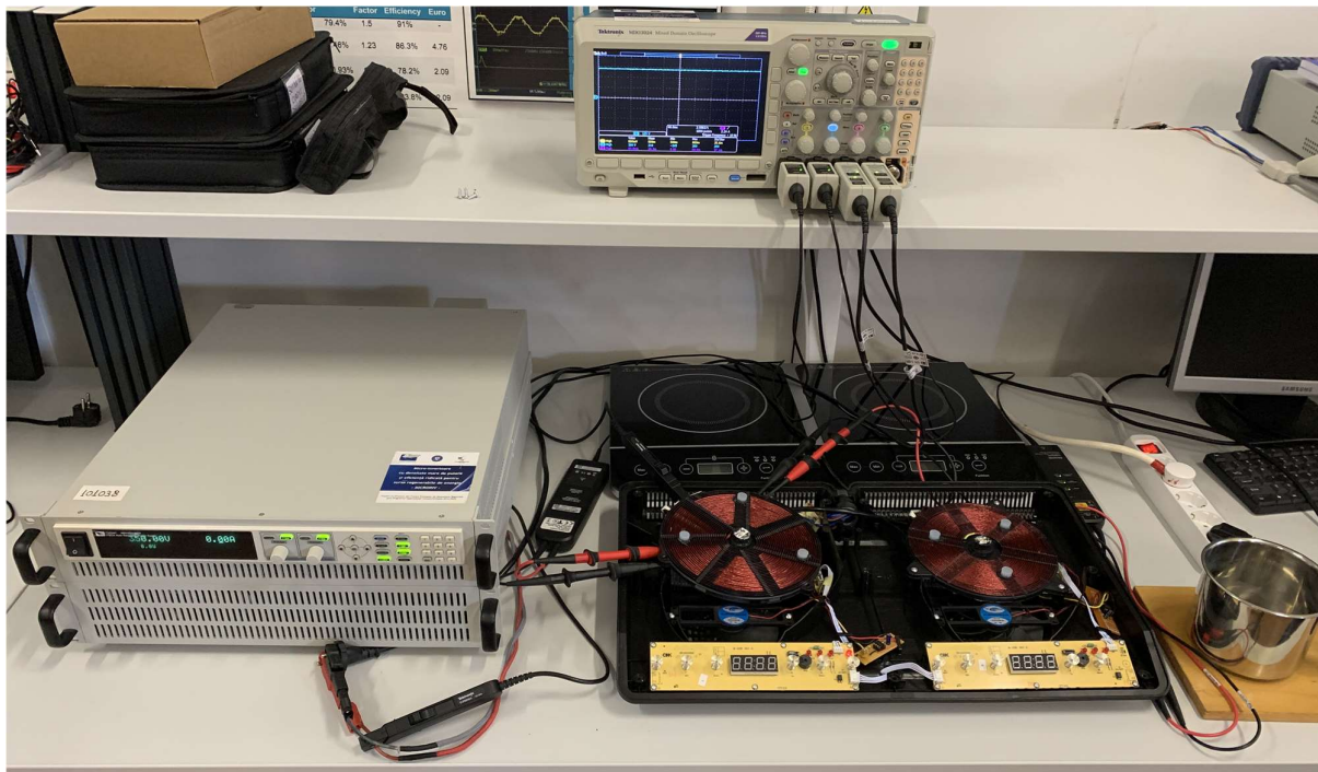
Fig. 48 Standul experimental de testare a plitei cu inducție.
