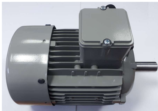
Fig. 26 Generatorul sincron cu excitație electromagnetică asamblat
