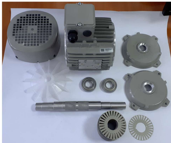
Fig. 23 Componentele utilizate pentru fabricarea generatorului sincron cu excitație electromagnetică
